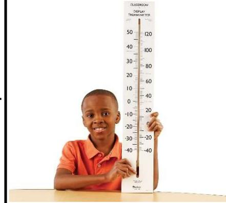
يتميز هذا الترمومتر الكبير الحجم بأنبوب مكبر زجاجي كبير ودقيق، بطول 30 سم، مملوء بالكيروسين - يتراوح نطاق قياسه بين -30 درجة مئوية و50 درجة مئوية
